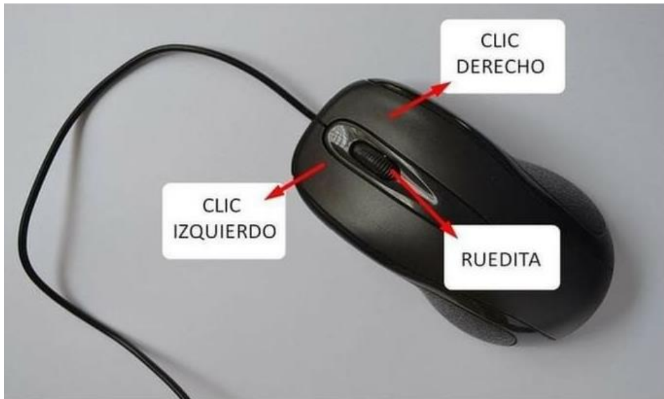
Figura 09: Partes de un mouse.
